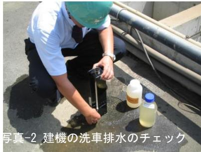
写真-2 建機の洗車排水のチェック
